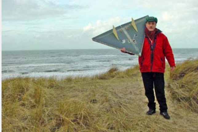
'pibros' van 1 meter 22 spanwijdte (opgebouwd uit een aantal 6mm depronlagen)
